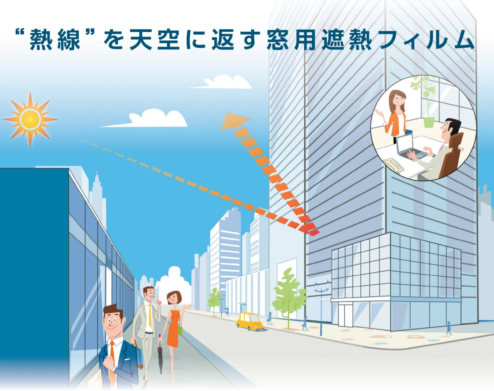
従来の遮熱フィルムでは難しかった、上方からの近赤外線（以下、熱線）を上方に反射することを可能とした新しいタイプの窓用遮熱フィルムです。建物の窓から室内へ侵入する熱線を遮断することで、室内温度の上昇を抑制すると同時に、反射によって地表に向かう熱線を減らすことで、建物周辺の地表温度の上昇も抑制します。室内の熱環境はもちろん、建物周辺の熱環境の改善も期待できます。
