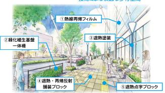
先進技術による日射の照り返し防止(再帰反射技術)と熱線(赤外線)抑制手法 のご提案。
