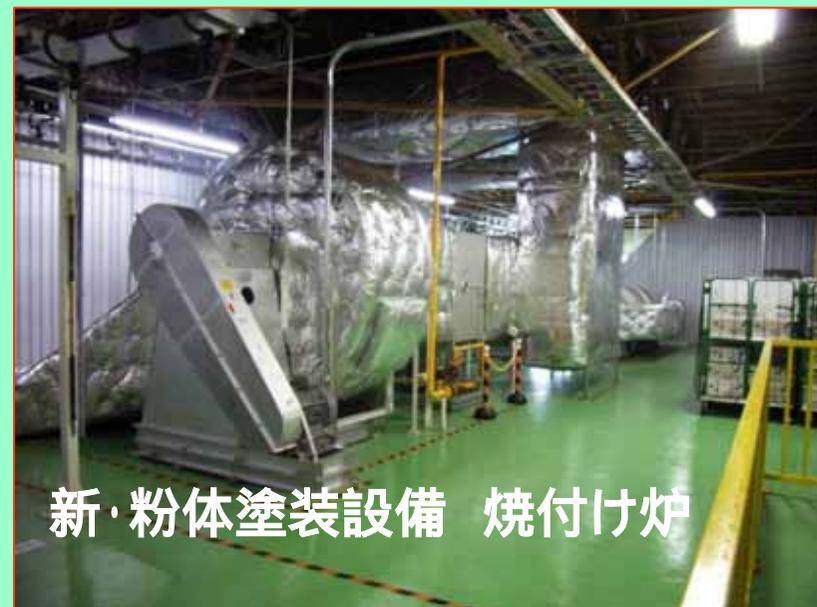
新・粉体塗装設備 焼付け炉
