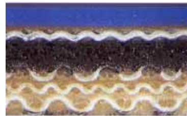
ブランケット断面の拡大写真 Magnified cross-section of a printing blanket.
